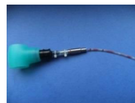
Bild 5: Anschluss HD 450 mit Adapter und Indikator
