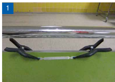
Beispiel für die Befestigung der Indikatoren mit Klammern am Kopf- oder Fußteil des Bettes
