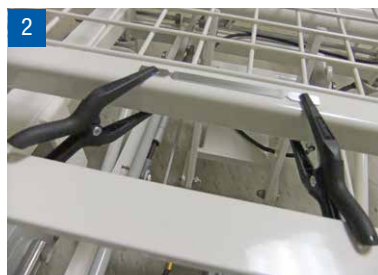
Beispiel für die Befestigung der Indikatoren mit Klammern an der Verstrebung der Matratzenauflage .
