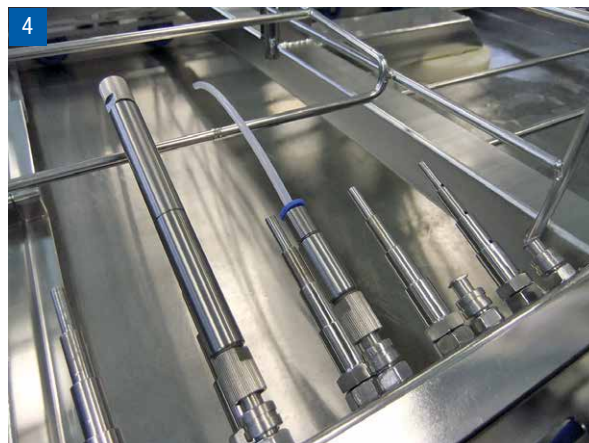
RDG-Check sowie Vario-Adapter mit Luer-Lock-Anschluss. Mit diesen Adaptern können Sie die Aufbereitung der dort anzuschließenden Materialien prüfen.
