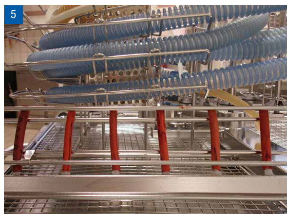
Indikatoren zum Aufstecken auf Spüldüsen
