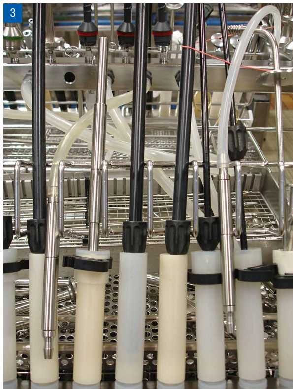
RDG-Check mit Verlängerungen zum Einsatz im Spültrichter zur Simulation der Aufbereitung von MIC-Instrumenten und mit Schlauchtüllen, zur Prüfung der Schlauchanschlüsse.
