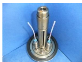
Bild 4: DAC UNIVERSAL Spülkopf mit Adaptern und Indikatoren
