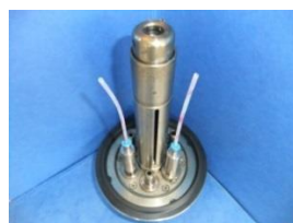
Bild 4: DAC UNIVERSAL mit Adaptern und Indikatoren
