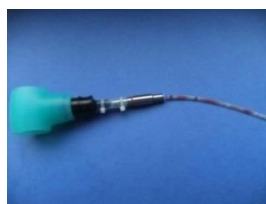
Bild 5: Anschluss HD 450 mit Adapter und Indikator
